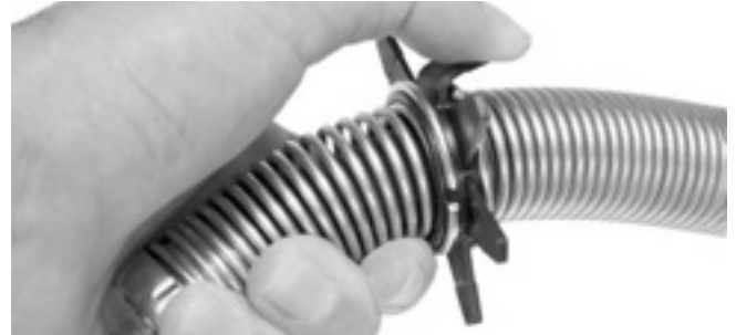
Figure 19 – Assouplissement des pointes d'étoile en les repliant délicatement à l'équerre dans les deux sens.
